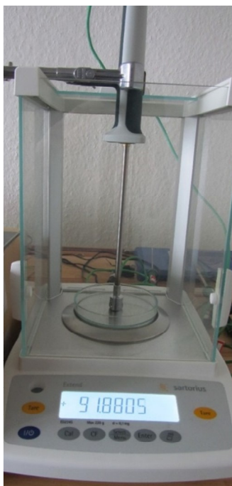
Obrázek 36 Správná orientace při vážení sondy povrchového teploměru
